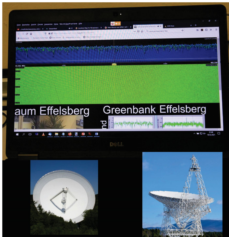
Abb. 3: Das Radiosignal vom Marsrover Perseverance der NASA wurde während der entscheidenden sieben Minuten der Landung auf der Marsoberfläche von den beiden weltweit größten beweglichen Radioteleskopen (Effelsberg & Green Bank/USA) aufgezeichnet. Das grünliche „Wasserfalldiagramm“ zeigt das Signal im linken Bildteil als schräg verlaufende dunkle Linie (Bilder: Norbert Junkes, NRAO/GBT).
