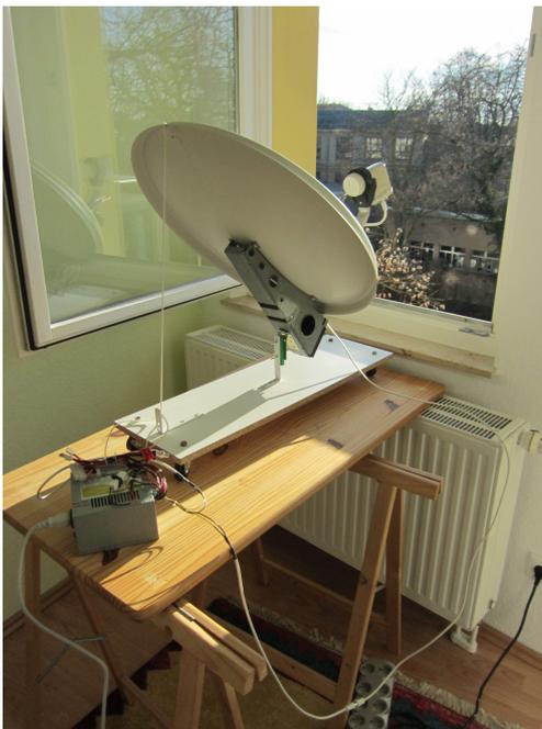
Abb. 22: Aufbau des Radioteleskops zur Messung am Fenster
