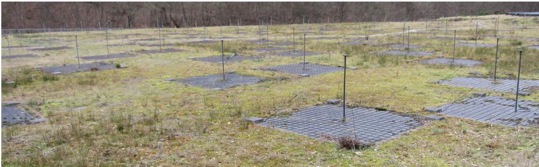
Abb. 24: LOFAR-Antennen auf dem Gelände des Radioteleskops Effelsberg
