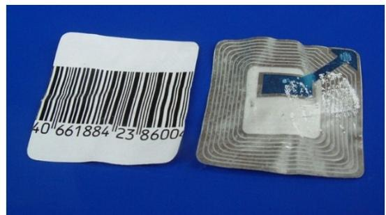
Abb. 11: Warensicherungsetikett mit Spule und Kondensator (Ref.3.7: Wikipedia)
