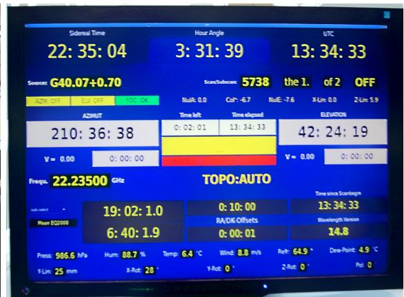
Abb. 22: Kontrollmonitor um 13:34 Uhr geplante Ausrichtung ins Sternbild Adler (Azimut: 210°, Höhe: 13°)
