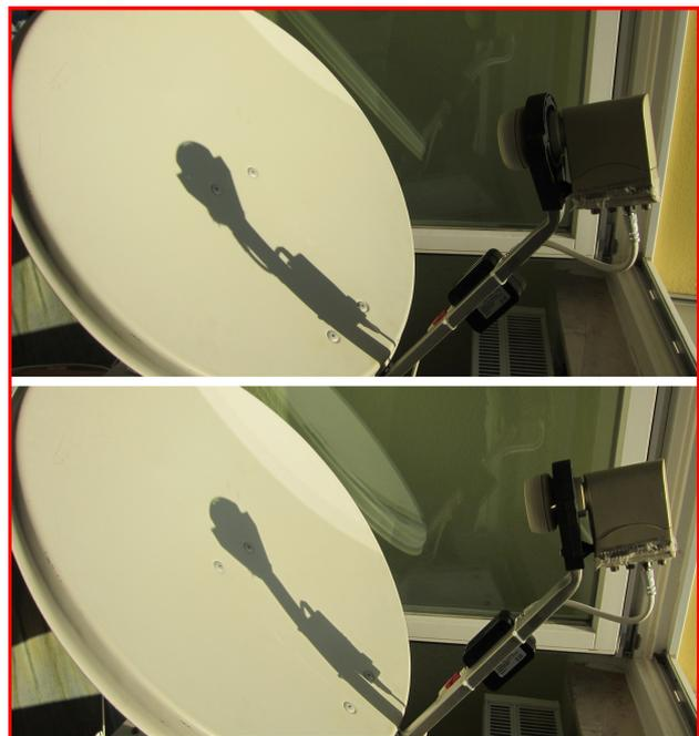
Abb. 23: Nieten als Anhaltspunkte für Start- und Endpunkt der Messungen
