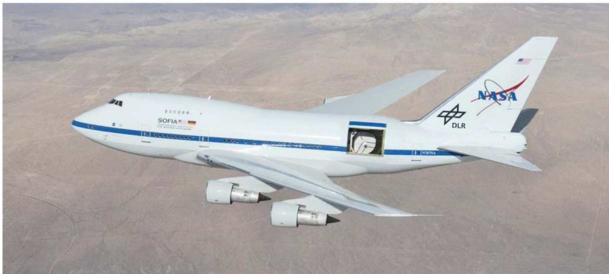
Abb. 7: Das amerikanisch-deutsche Flugzeug-Observatorium SOFIA zur Beobachtung von Infrarotstrahlung in 13-14 km Höhe. Der Spektroskopie-Empfänger GREAT wurde in Deutschland gebaut (MPIfR, Univ. Köln). (Bild: NASA/DLR).
