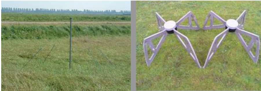
Abb. 1: Einzelne LOFAR Dipol-Antenne für die Frequenzbereiche 30-80 MHz (links) und 110-240 MHz (rechts).
