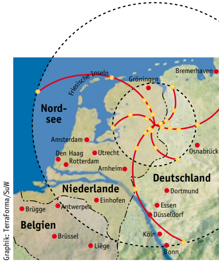
▲ Abb. 7: Oben links: Schematische Darstellung der Anordnung der Stationen von LOFAR. Der Durchmesser des Kreises beträgt 350 km. Oben rechts: Eine zukünftige LOFAR-Station (künstlerische Darstellung) besteht aus Dipolantennen des Typs »Inverted V«. Unter jeder Antenne befindet sich ein flacher runder Reflektor. Unten rechts: Photo von installierten Antennen auf einem Testfeld in Exloo, Holland.
