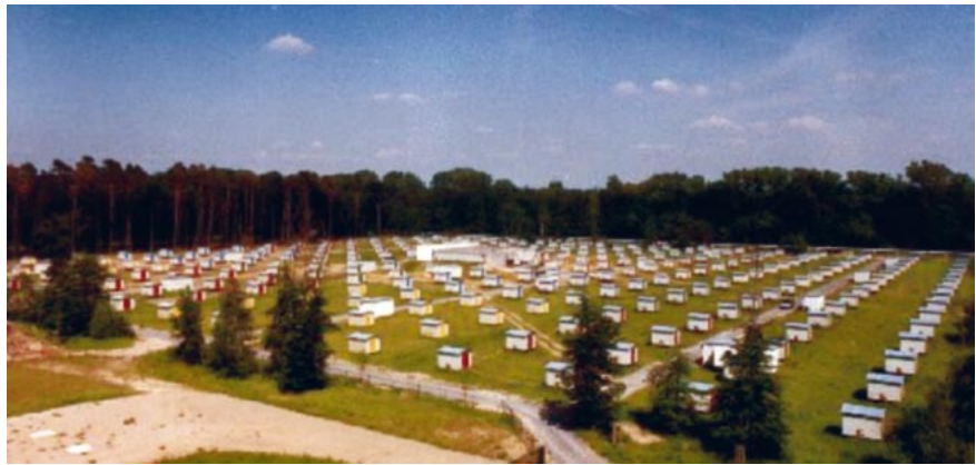
▲ Abb. 11: Das Luftschauerexperiment KASCADE (jetzt KASCADE GRANDE) im Forschungszentrum Karlsruhe. Hier werden kosmische Teilchenschauer gemessen. Zur Zeit wird dort ein LOFAR-Prototyp (LOPES) errichtet, um die Radioemission dieser Schauer in Koinkidenz zu messen. Mit dieser Kreuzkalibration lässt sich hinterher LOFAR auch als kosmisches Teilchenexperiment betreiben.
