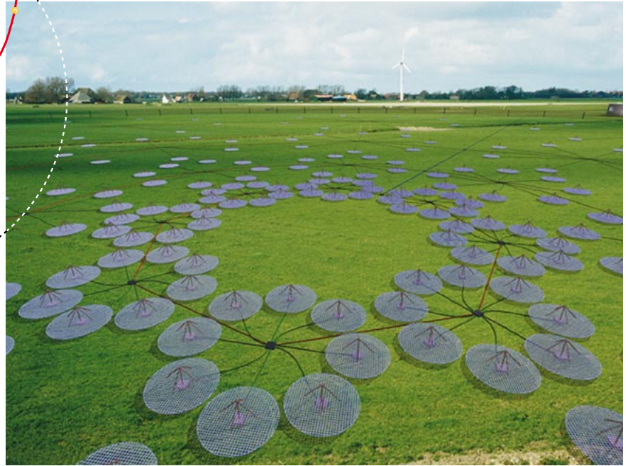
▲ Abb. 7: Oben links: Schematische Darstellung der Anordnung der Stationen von LOFAR. Der Durchmesser des Kreises beträgt 350 km. Oben rechts: Eine zukünftige LOFAR-Station (künstlerische Darstellung) besteht aus Dipolantennen des Typs »Inverted V«. Unter jeder Antenne befindet sich ein flacher runder Reflektor. Unten rechts: Photo von installierten Antennen auf einem Testfeld in Exloo, Holland.
