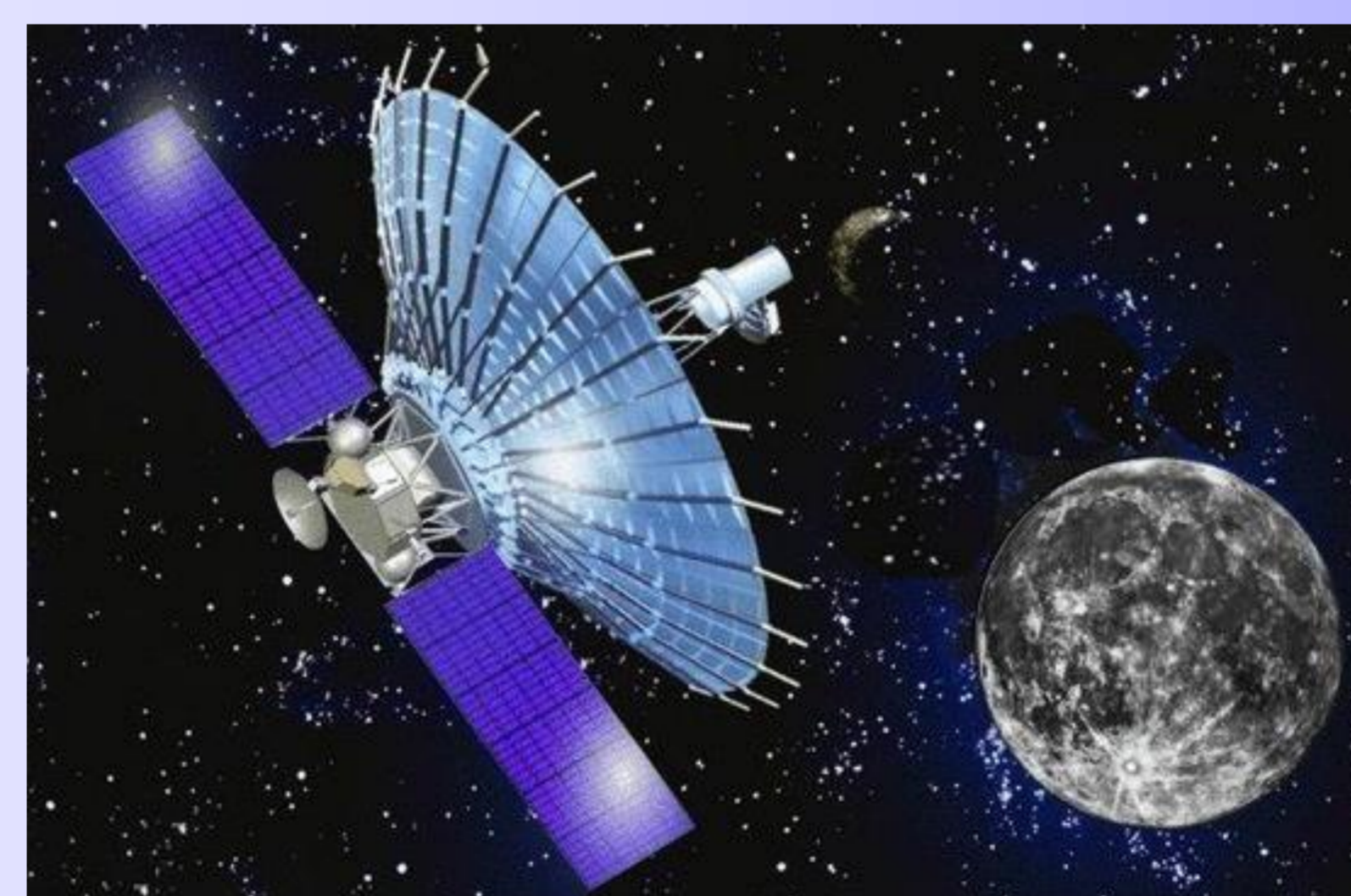
Abb. 2: Künstlerische Darstellung des 10-m-Weltraum-Radioteleskops an Bord des russischen Spektr-R Satelliten, der die Weltraumkomponente des RadioAstron-Projekts darstellt. (Bild: Astro Space Center of Lebedev Physical Institute)
